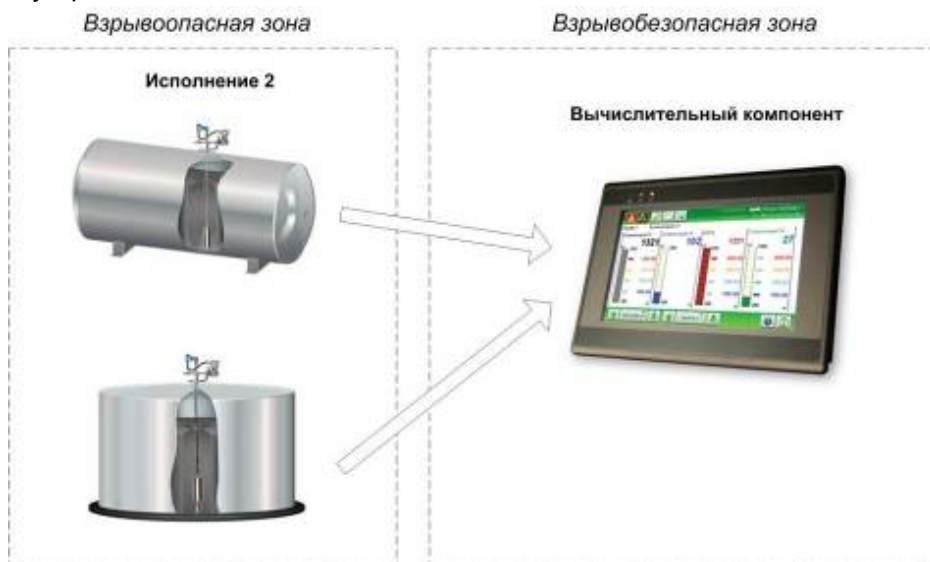
Рисунок Б.2. Общее устройство системы исполнения 2
