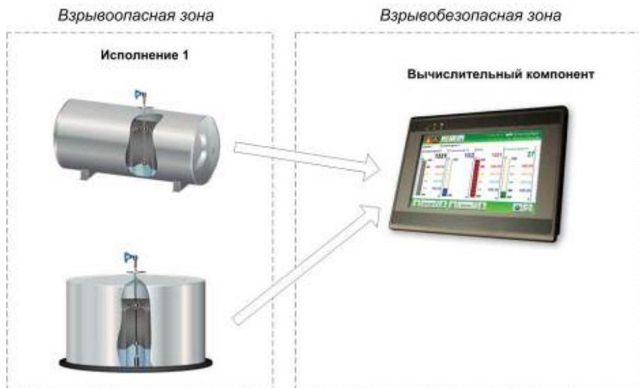
Рисунок Б.1. Общее устройство системы исполнения 1
