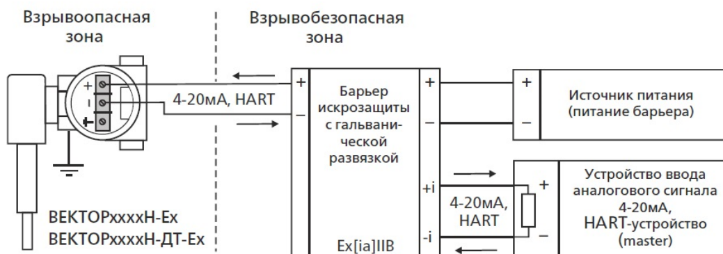
РИСУНОК 26. Схема подключения уровнемеров ВЕКТОРXXXXH-Ex, ВЕКТОРXXXXH-ДТ-Ex с применением барьера искрозащиты, имеющего гальваническую развязку искробезопасных цепей и цепей питания.
